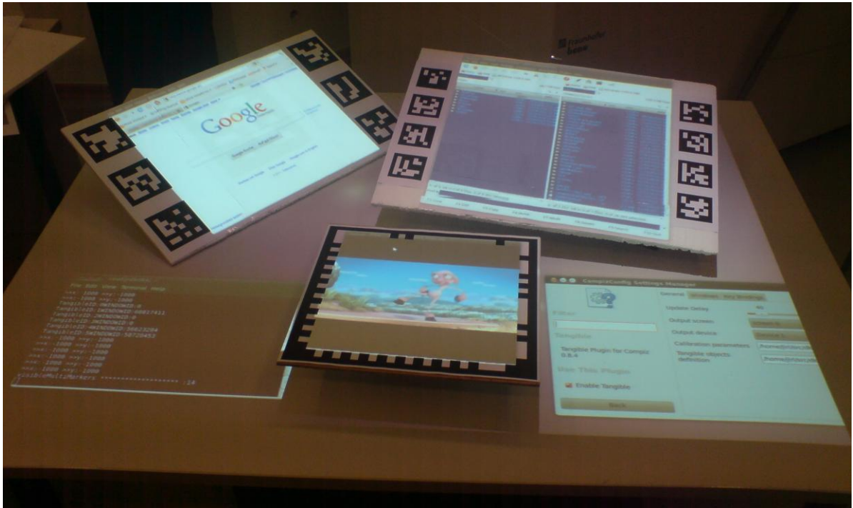
Obrázek 4: Promítání aplikačních oken nově vytvořeným systémem s podporou Compiz. Desky nahoře jsou označeny tzv. multimarkery. Deska uprostřed je označena tzv. frame markerem.
